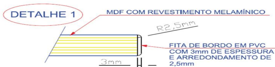
Figura 23 - Detalhe - medidas em milímetros módulo complementar
